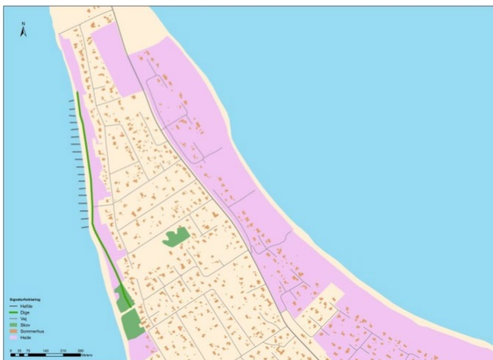
Figur A7 Projektscenarie 1: Dige med høfder foran
