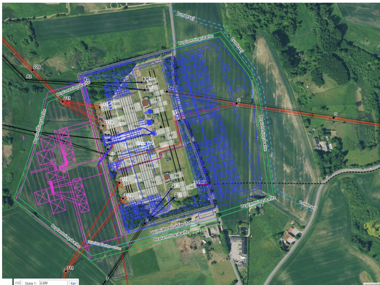
Figur 8 Luftfoto af hele stationsområdet ved Hovegård med den forventede udbygning. Med grønne linjer (beplantningsbælte) er afgrænsningen af en fuldt udbygget station markeret. Den blå stiplede linje til højre i billedet er en cirka-angivelse af vejforlægningen. Det samlede areal af Hovegård højspændingsstation er med en fuldt udbygget station på 20 ha. Aktørens station (lilla farve) skal bygges vest for den eksisterende station. Med blå farve er markeret alle de udbygninger Energinet forventer at foretage i forbindelse med tilslutning af Hesselø havvindmøllepark, sanering af 132 kV AIS-anlæg, som erstattes af ny GIS-station og en forstærkning af transmissionsnettet mod København og forskønnelsesprojekter i Nordsjælland.
