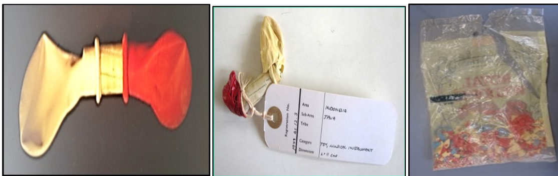
Legetøjsfløjte fra Java monteret med nye balloner i 1990 (til venstre). Samme fløjte og balloner år 2000 med tydelige tegn på nedbrydning pga. oxidation (midt). Efter 20 år i den originale indpakning er ballonerne nedbrudt til små stykker (til højre). (Foto: Yvonne Shashoua)
