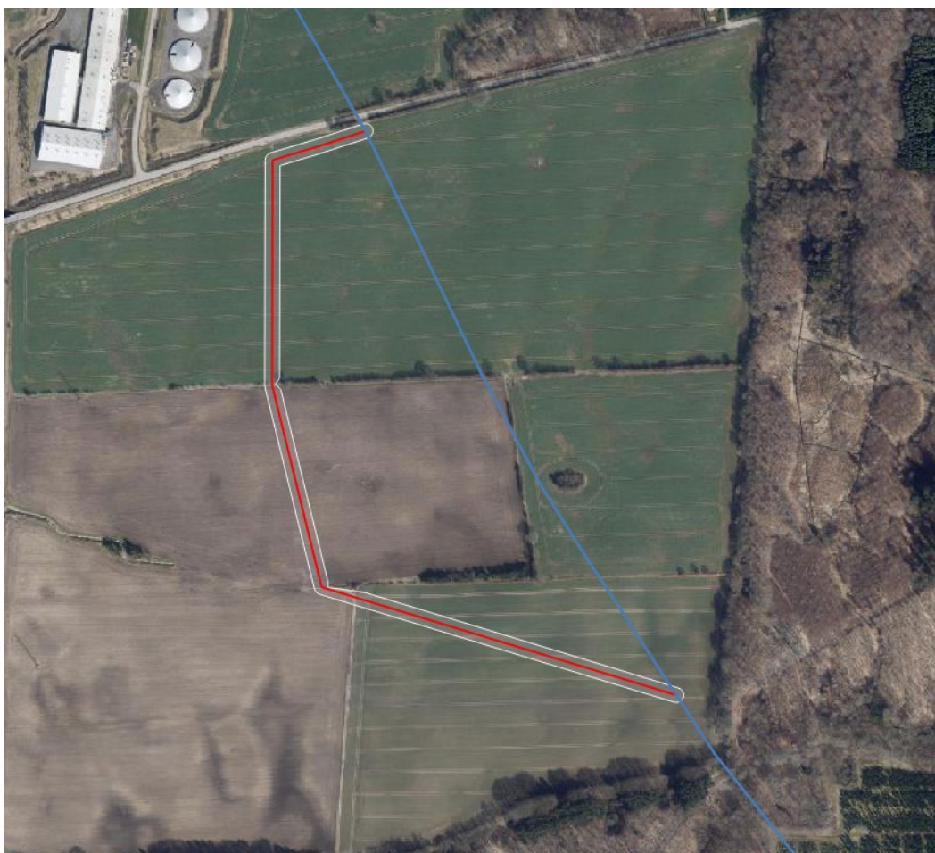
Figur 3 Den eksisterende gasledning er vist med blå og omlægning til en ny linjeføring af gasledningen er vist med rødt.
