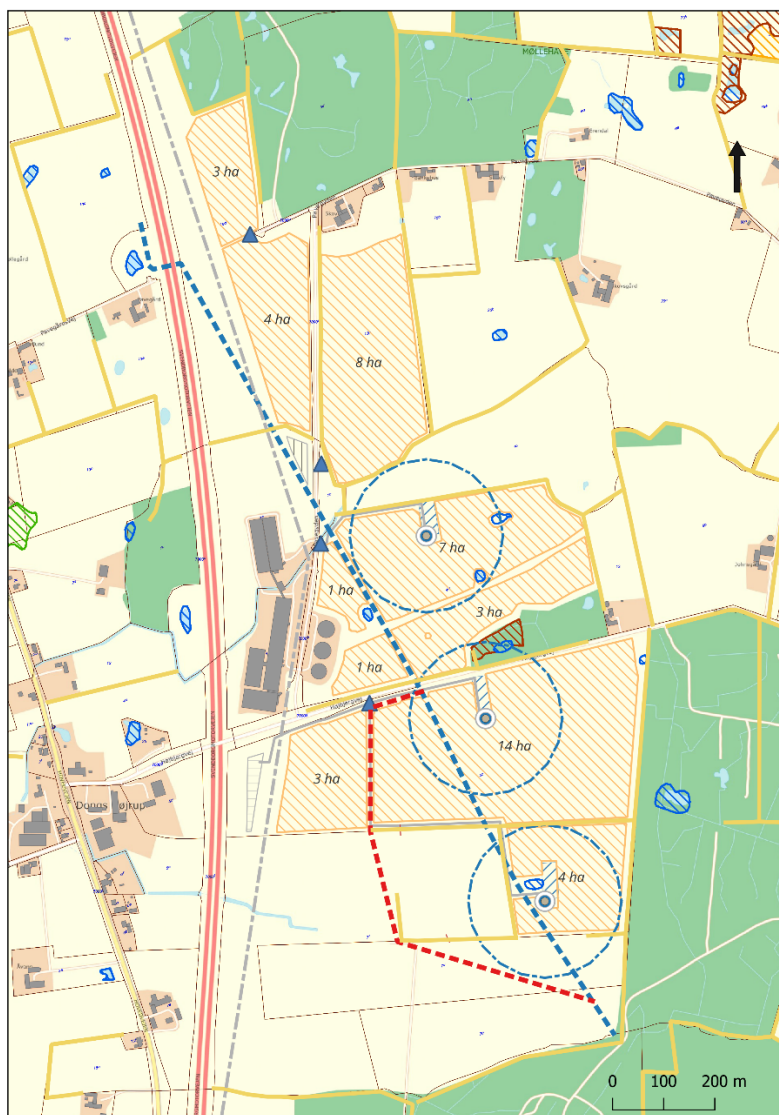
Figur 2 Anlæg i projektområdet med tre vindmøller, solceller og omlægning af gasledning
