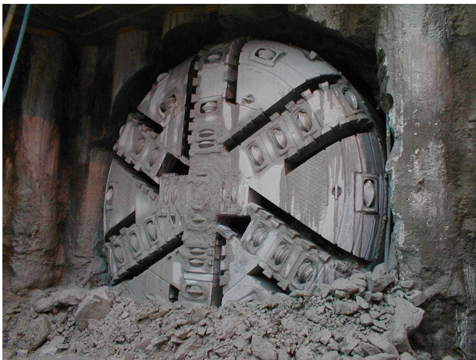
Figur 3.1 Frontskjoldet på en tunnelboremaskine.
