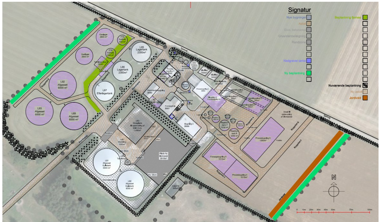
Figur 3.4. AU-Foulum biogasanlæg fuldt udbygget med yderligere reaktorer, bioraffinering og opgradering af biogas (set fra syd). Eksisterende bygninger og anlæg er markeret hvide. Nye bygninger og anlæg er skravet lilla (Bilag 2).
