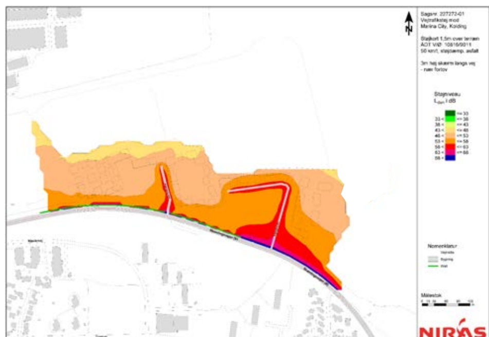
Figur 7-10: Vejtrafikstøj ved Marina city i 1,5 m over terræn med 3 m af-skærmning i bagkant fortov og med hastighedsdæmpning på Skamlingvejen til 50 km/t og støjdæmpende asfalt (NIRAS, 2018b).
