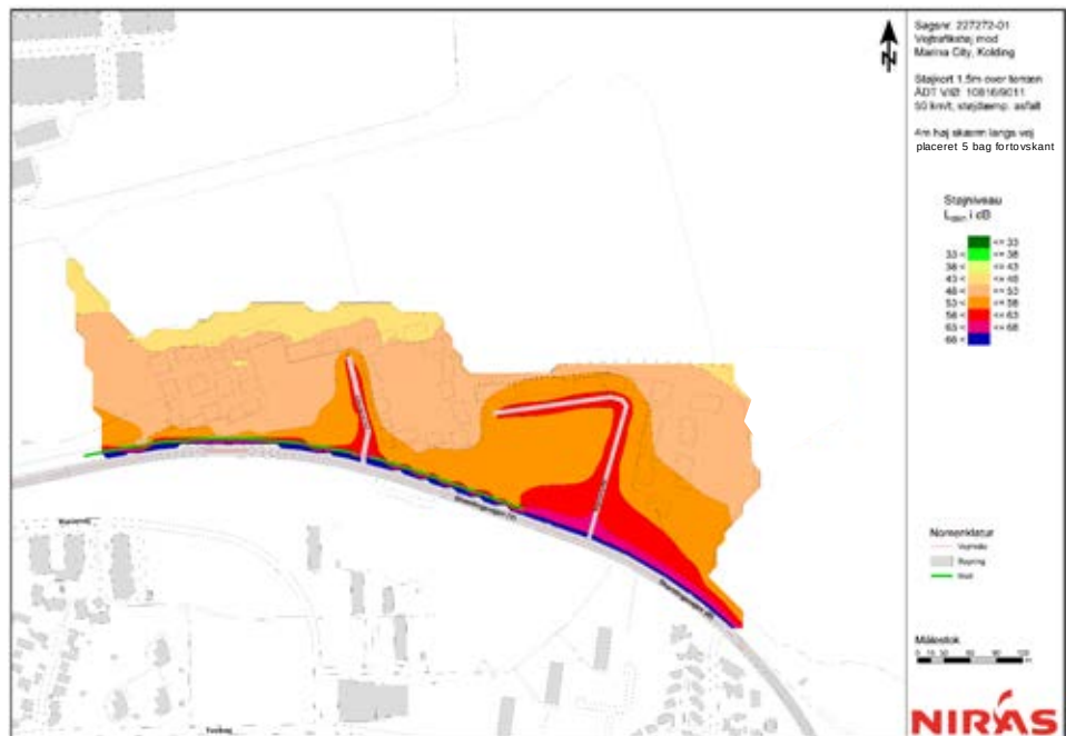
Figur 7-11: Vejtrafikstøj ved Marina city i 1,5 m over terræn med 4 m afskærmning 5 m fra bagkant fortov og med hastighedsdæmpning på Skamlingvejen til 50 km/t og støjdæmpende asfalt (NIRAS, 2018b).
