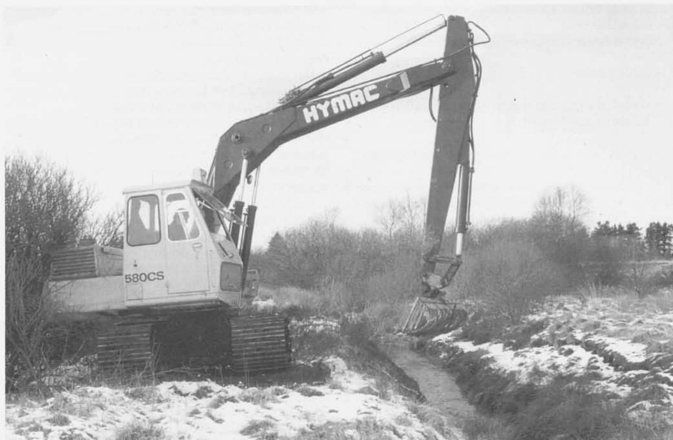
Figur 11.7. Gravemaskine med mejekurv bør normalt ikke anvendes til grødeskæring i vandløb, hvor der skal tages hensyn til miljøet. Foto: Ulrich Kern-Hansen
