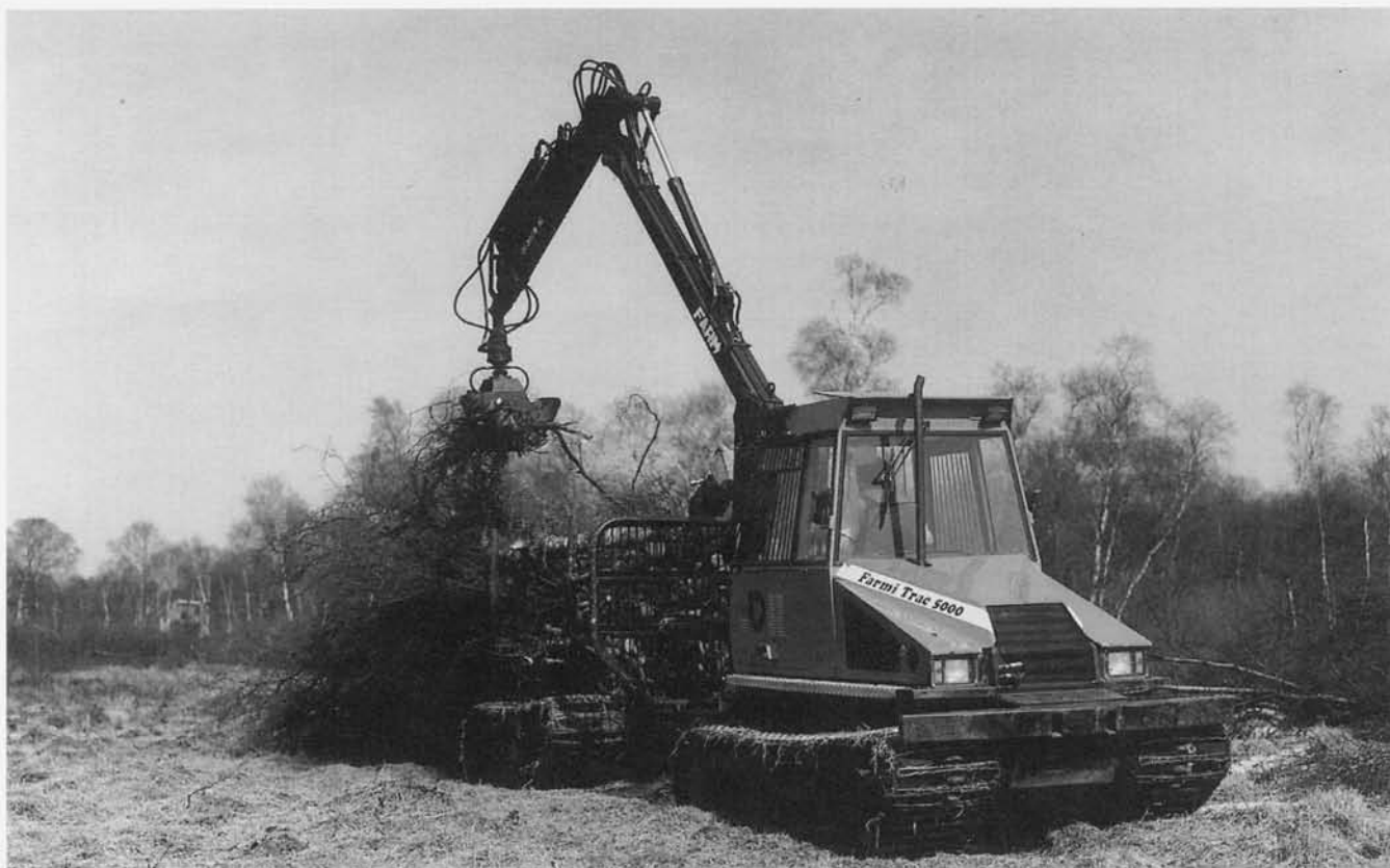
Figur 4.3. Ved fjernelse af fældede birke i Holmegårds Mose benyttes gravko og transportvogn på larvefodder, som ikke synker ned i den ret bløde bund. Foto: Niels Westergaard Knudsen/Biofoto
